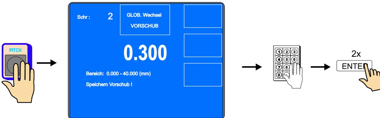
So wird Vorschub in allen folgenden Wickelschritten gewechselt werden.
