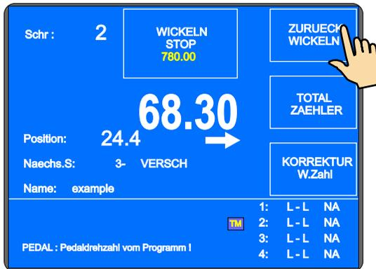
Jetzt können wir mittels Pedal geforderte Windungszahl abwickeln, wobei Windungszahl auf der Anzeige abgerechnet wird und Drahtführer kehrt sich zurück.
