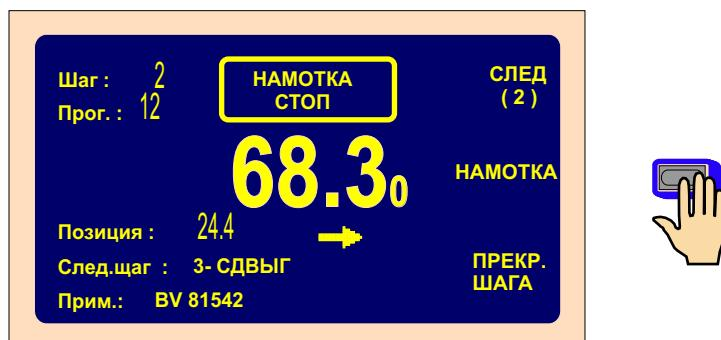
После нажатия на многофункциональную кнопку «НАМОТКА» процесс отматывания закончится.
