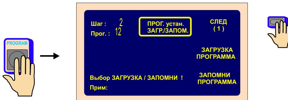
После составления программы рекомендуется с помощью функции «ПРИМЕЧАНИЯ» присвоить программе название (название, процедура намотки итд.). Присваивание программам названий обеспечит обзорность и быструю ориентацию в программах.
