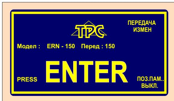
изображающее информацию о типе намоточного станка, установленном в коробке управления. Вводное окно позволяет осуществить изменение значения передачи, которое безусловно ДОЛЖНО ОТВЕЧАТЬ действительно установленной механической передаче.
